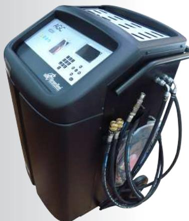
La estación AGC ha sido diseñada para cambiar todo el aceite del cambio automático y limpiar el circuito correspondiente en todos los modelos de coche.
