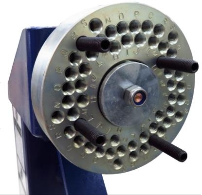
El GAHO-710 permite rectificar todo tipo de aros de acero y también de aleación, entregando excelentes resultados en poco tiempo. El equipo incorpora una guía (dial) de presión con el cual se lograra determinar fácilmente las imperfecciones. El equipo puede rectificar aros hasta rin" 24, La corrección se realiza fácilmente gracias al gato hidráulico incorporado.
