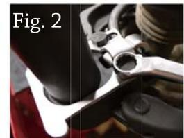
Paso 3: Use una llave de 24mm o una llave de aire para mover a la derecha (hacia las agujas del reloj) la tuerca en la parte superior del cuerpo para comprimir el resorte a como muestra la figura 1.
